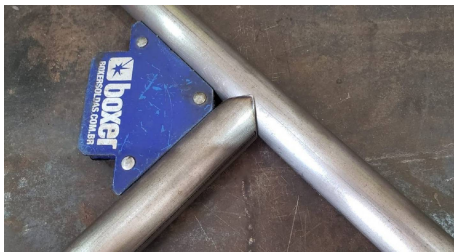
DETALHE TUBOS HORIZONTAIS E DIAGONAIS C/ EXTREMIDADES C/ CORTE BOCA DE LOBO S/ ESCALA
